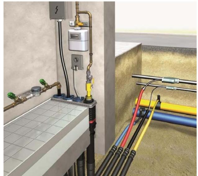
Abbildung 3: Mehrspartenhausanschluss, Quelle: DOYMA Mehrsparte
